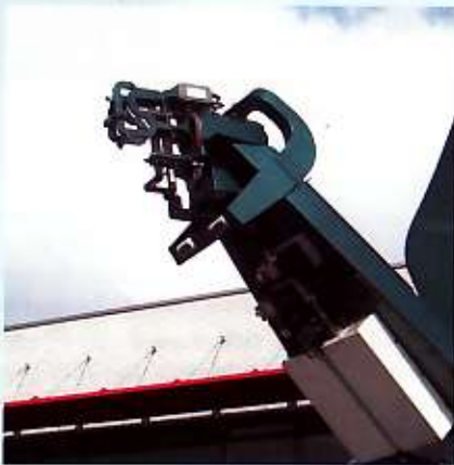
Alles tot en met de golfpijpen is dubbel uitgevoerd. De witte behuizingen zijn de HPA's.
